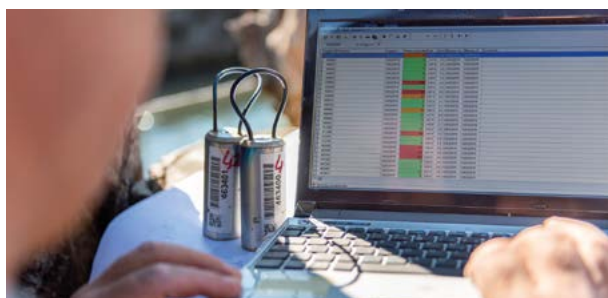
Figura 1. Viacqua – Ricerca perdite: i dati raccolti dagli strumenti vengono caricati e analizzati digitalmente.
