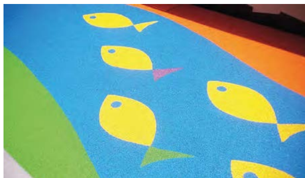
Figura 2. Pavimentazione antitrauma derivante da granulato di PFU.
