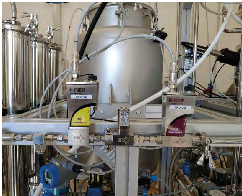
Figura 1. Metanatore biologico – Linea gas metano output
