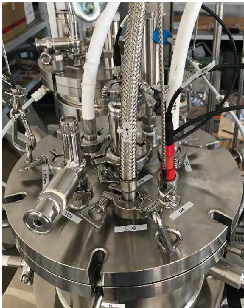
Figura 3. Metanatore biologico – Coperchio di chiusura reattore.
