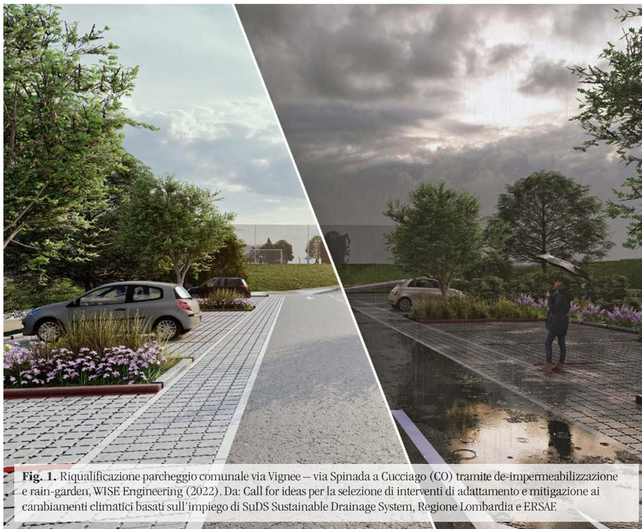
**Fig. 1.** Riqualificazione parcheggio comunale via Vignee – via Spinada a Cucciago (CO) tramite de-impermeabilizzazione e rain-garden, WISE Engineering (2022). Da: Call for ideas per la selezione di interventi di adattamento e mitigazione ai cambiamenti climatici basati sull'impiego di SuDS Sustainable Drainage System, Regione Lombardia e ERSAF.
