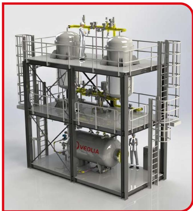
*MPPE (Macro porous polymer extraction) è la tecnologia di Veolia Water Technologies per la rimozione di idrocarburi dalle acque reflue delle industrie farmaceutiche.*
