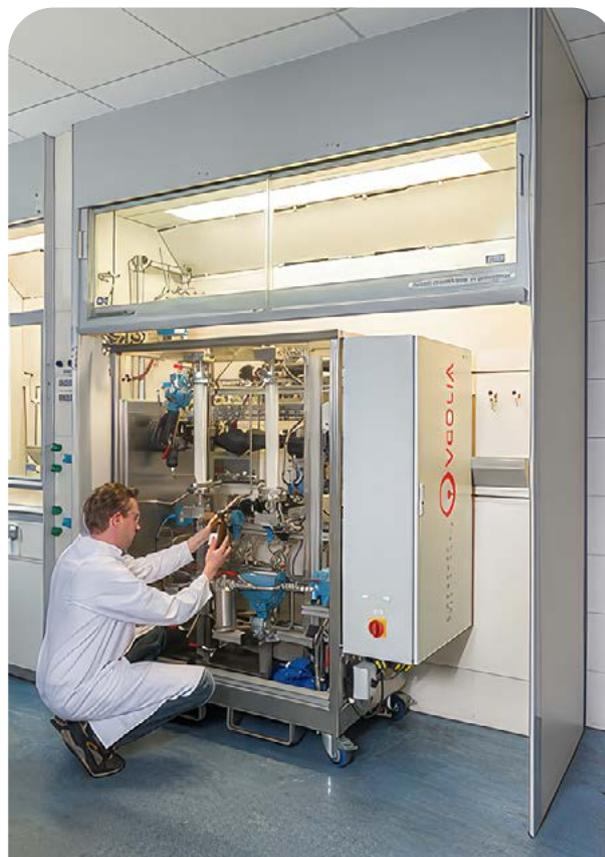
**Figura 1.** MPPE MicroUnit per prove pilota in scala in laboratorio.
