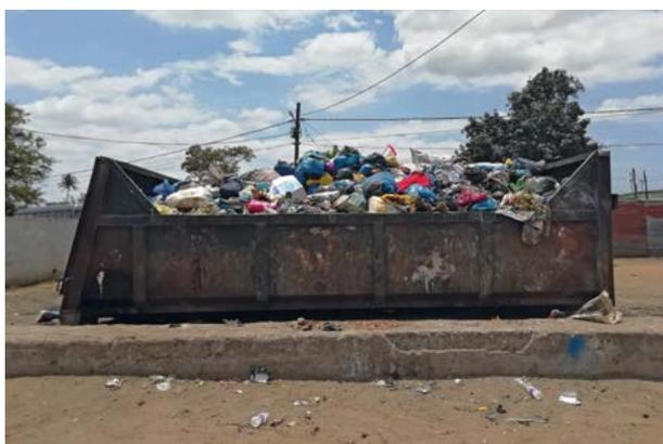
**Figura 7.** Contenitore da 12 m<sup>3</sup> (uno di tre collocati a Chamanculo C) per il conferimento dei rifiuti da parte delle microimprese che si occupano della raccolta primaria (ott. 2021)
