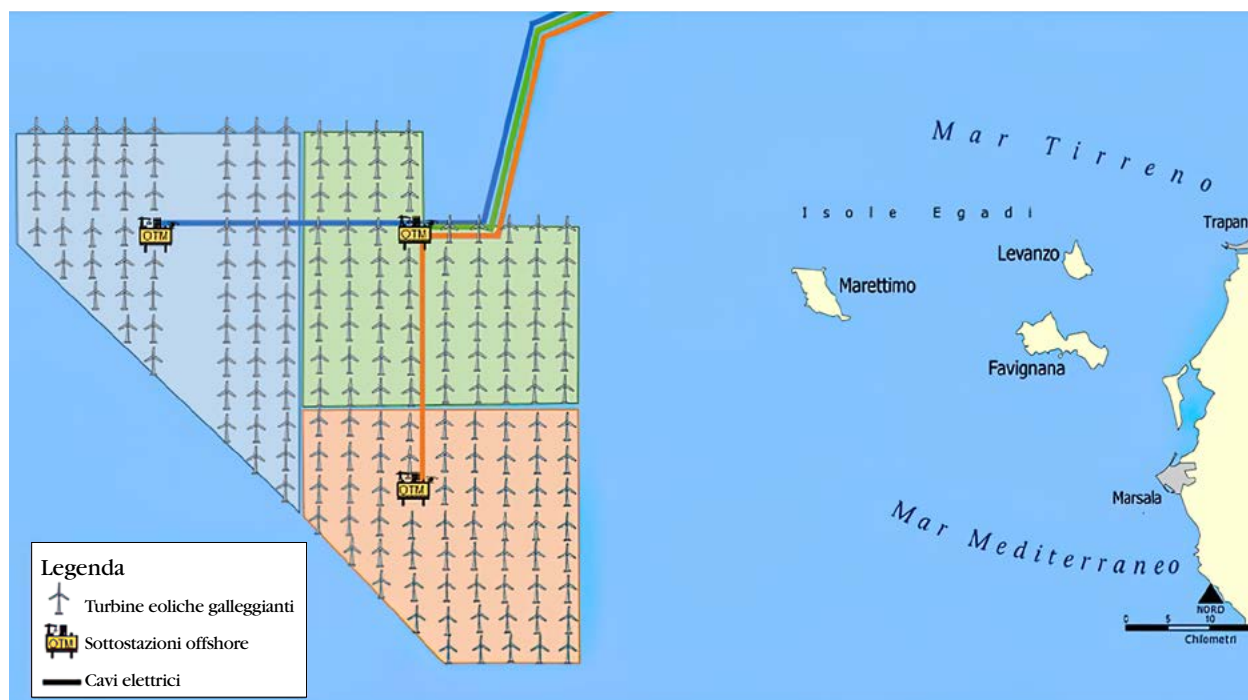
Figura 2. Layout dell'impianto; adattata da (Med Wind, 2020a).
