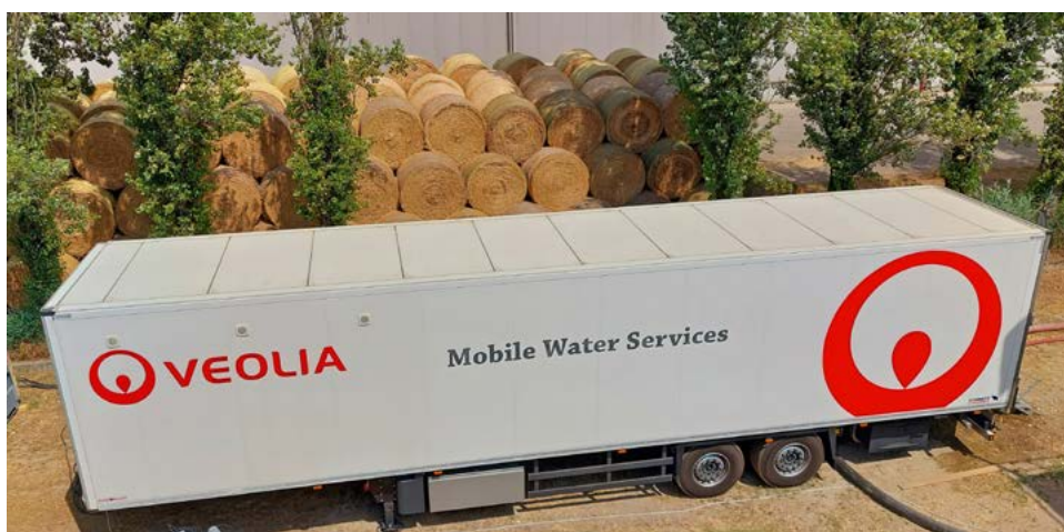
Figura 5. Installazione di un'unità mobile con tecnologia DAF.
