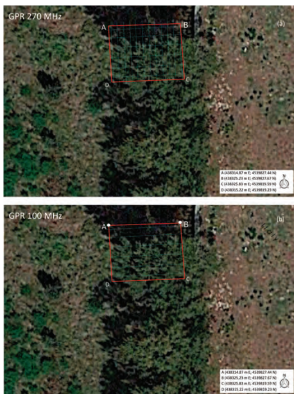
Figura 3 – a) Grid del rilievo GPR con antenna a 270 MHz; b) e a 100 MHz
