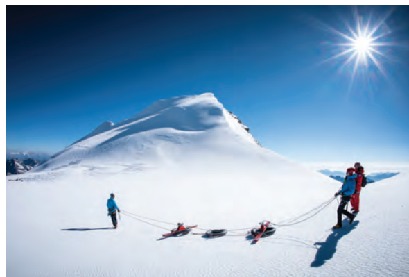
Figura 3 – Ricercatori impegnati nell’esecuzione di un profilo radar sul Grand Combin (Svizzera) nell’ambito del progetto Ice Memory. Photo credit @Riccardo Selvatico
