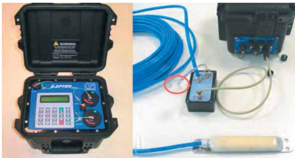
Figura 3 – KAPTOR MULTI e modulo OCM KAPTOR dotato di sensore a scarpetta
