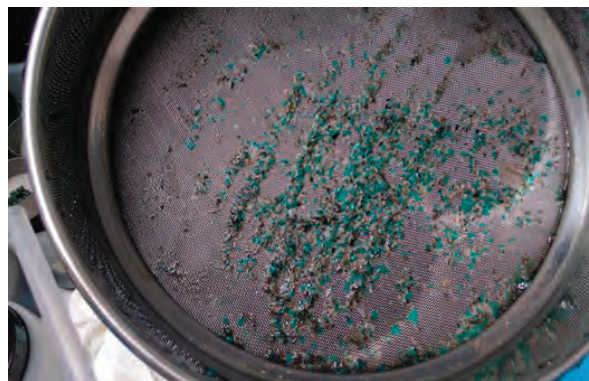
Figura 3 – Residui delle prove di BMP su BDB1 trattenuti dal setaccio di maglia 0,50 mm
