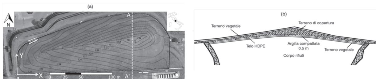
Figura 1 – (a) Planimetria dell'impianto di smaltimento; (b) Sezione tipo A-A' del lotto come riportata in Fig.1a con linea bianca tratteggiata
