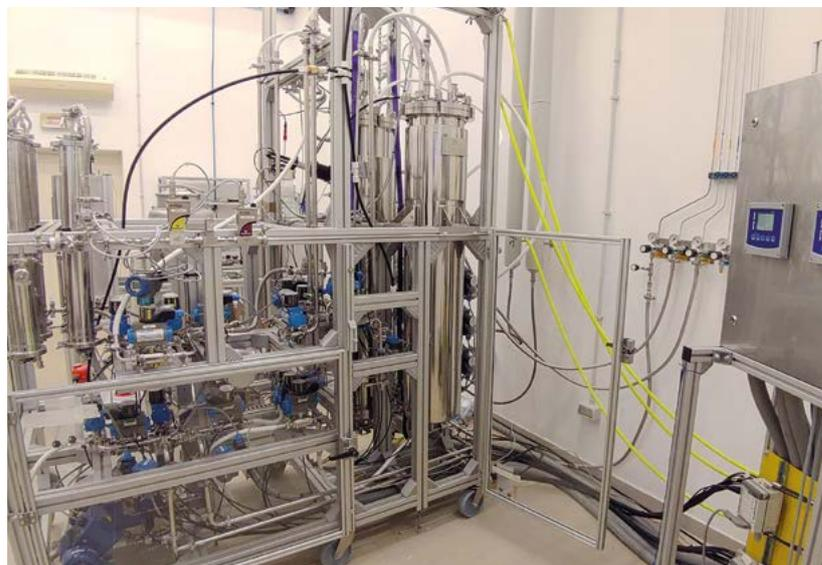
**Figura 2** Metanatore biologico – Skid d'impianto e quadro sensori
