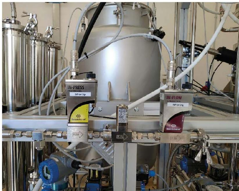
**Figura 1.** Metanatore biologico – Linea gas metano output
