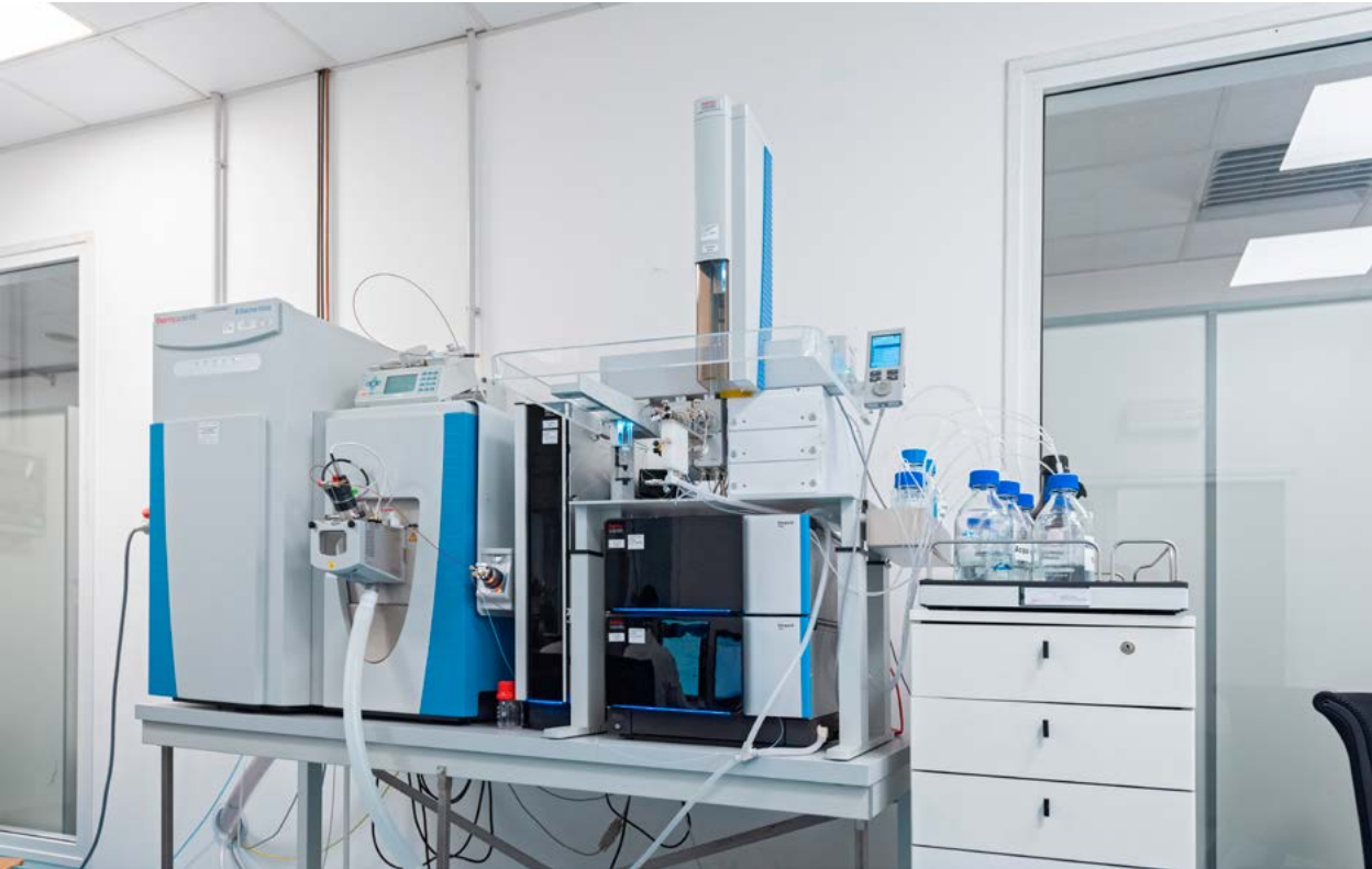
Figura 1. LC-MS/MS e HPLC MS/MS Orbitrap nei laboratori veneti di Mérieux NutriSciences Italia.
