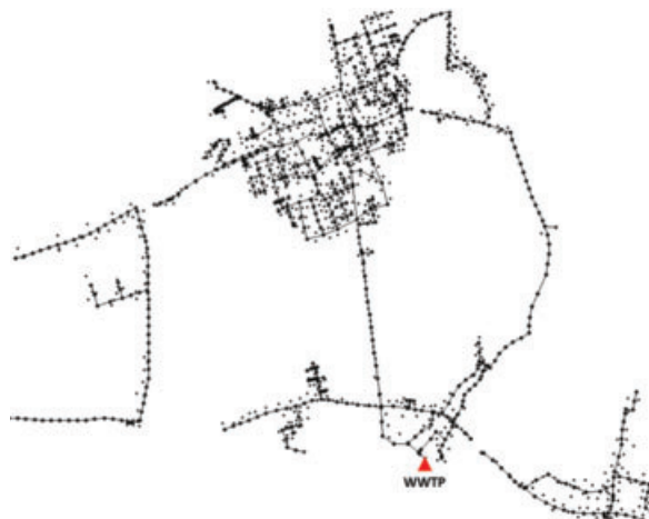
Figura 1 – Modellazione per mezzo del codice di calcolo EPA – SWMM della rete fognaria del comune di Remanzacco (UD) e localizzazione del relativo impianto di depurazione (WWTP)
