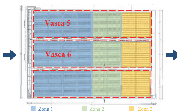
Figura 3 – Planimetria delle vasche di ossidazione e rappresentazione delle tre zone a eguale densità di diffusori
