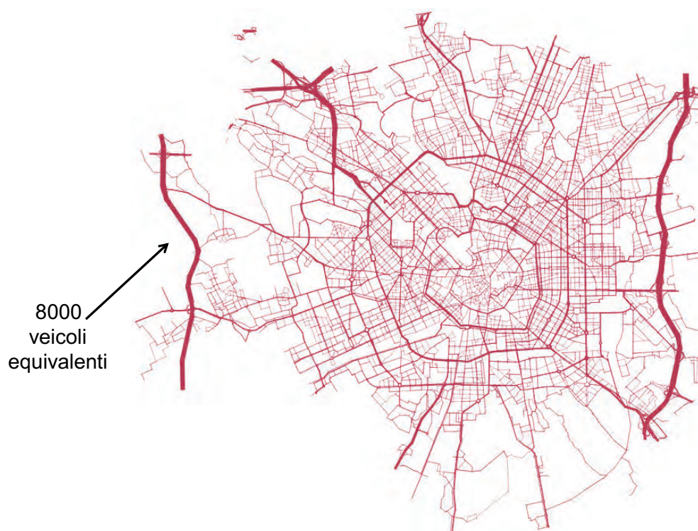
Figura 3 – Grafo stradale considerato per la stima delle emissioni veicolari a scala urbana. Il flusso di traffico del tratto di tangenziale ovest, a sud dello svincolo di Settimo Milanese, è indicato come riferimento ed è espresso come veicoli equivalenti nell'ora di punta del mattino
