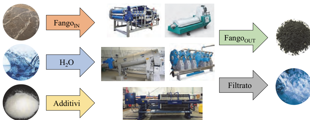
Figura 4 – Schema del processo di condizionamento e disidratazione
