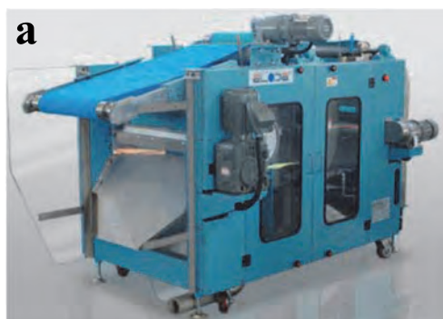
Figura 19 – Modelli Elode® per la disidratazione elettro-assistita: (a) SELO e (b) BELO (Ace Korea Incorporation Co. LTD, 2019)
