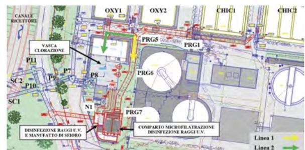
Figura 1 – Planimetria relativa agli interventi progettuali previsti (identificati con tratto colore rosso) finalizzati al potenziamento dell'impianto di depurazione della città di Udine
