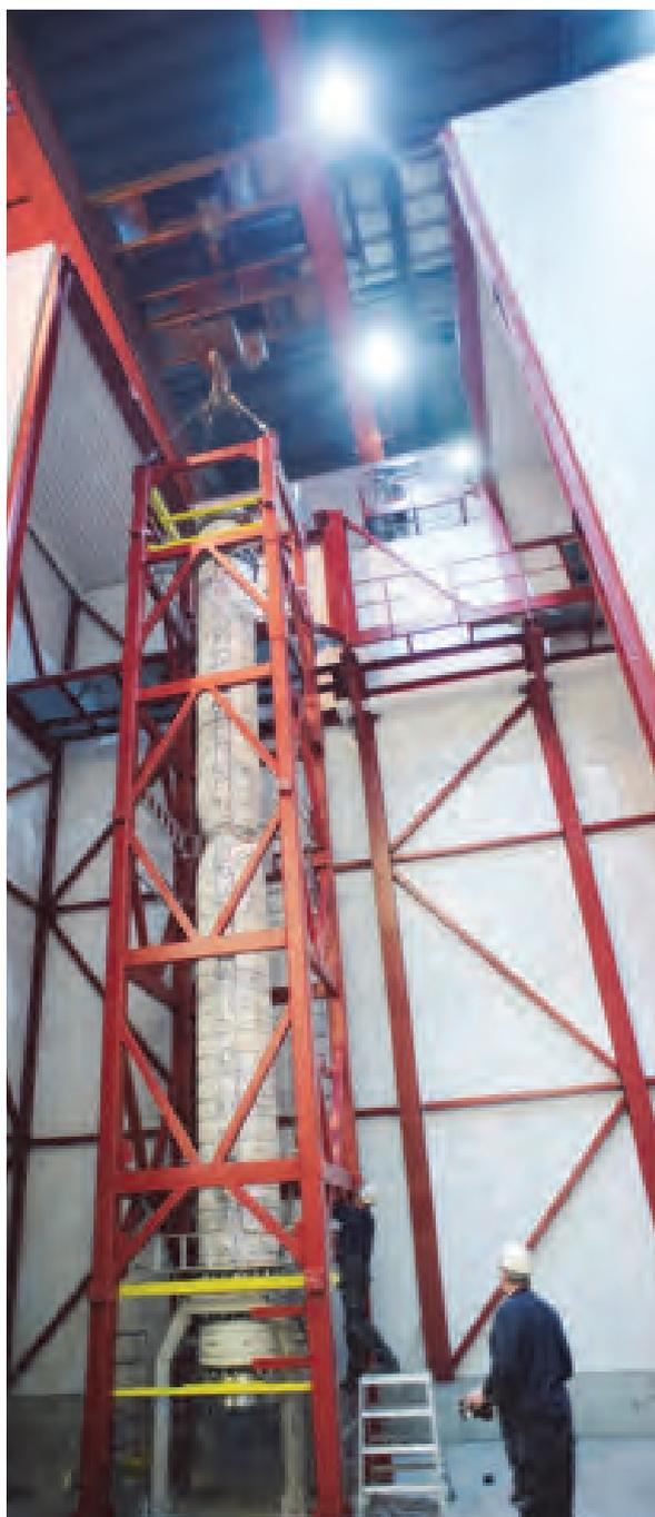
Figura 2 – Tecnologia SEWGS (*Sorption Enhanced Water Gas Shift*) per la separazione del flusso ricco di CO<sub>2</sub> dal flusso ricco di H<sub>2</sub> dai gas di scarico dell'acciaieria
